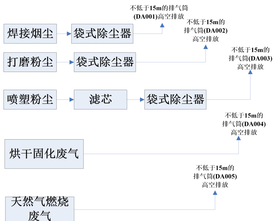
图 4-1 本项目废气处理方式
