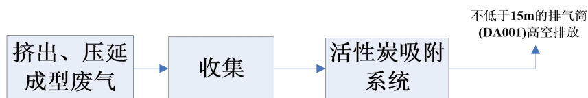
图 4-1 本项目废气处理方式
